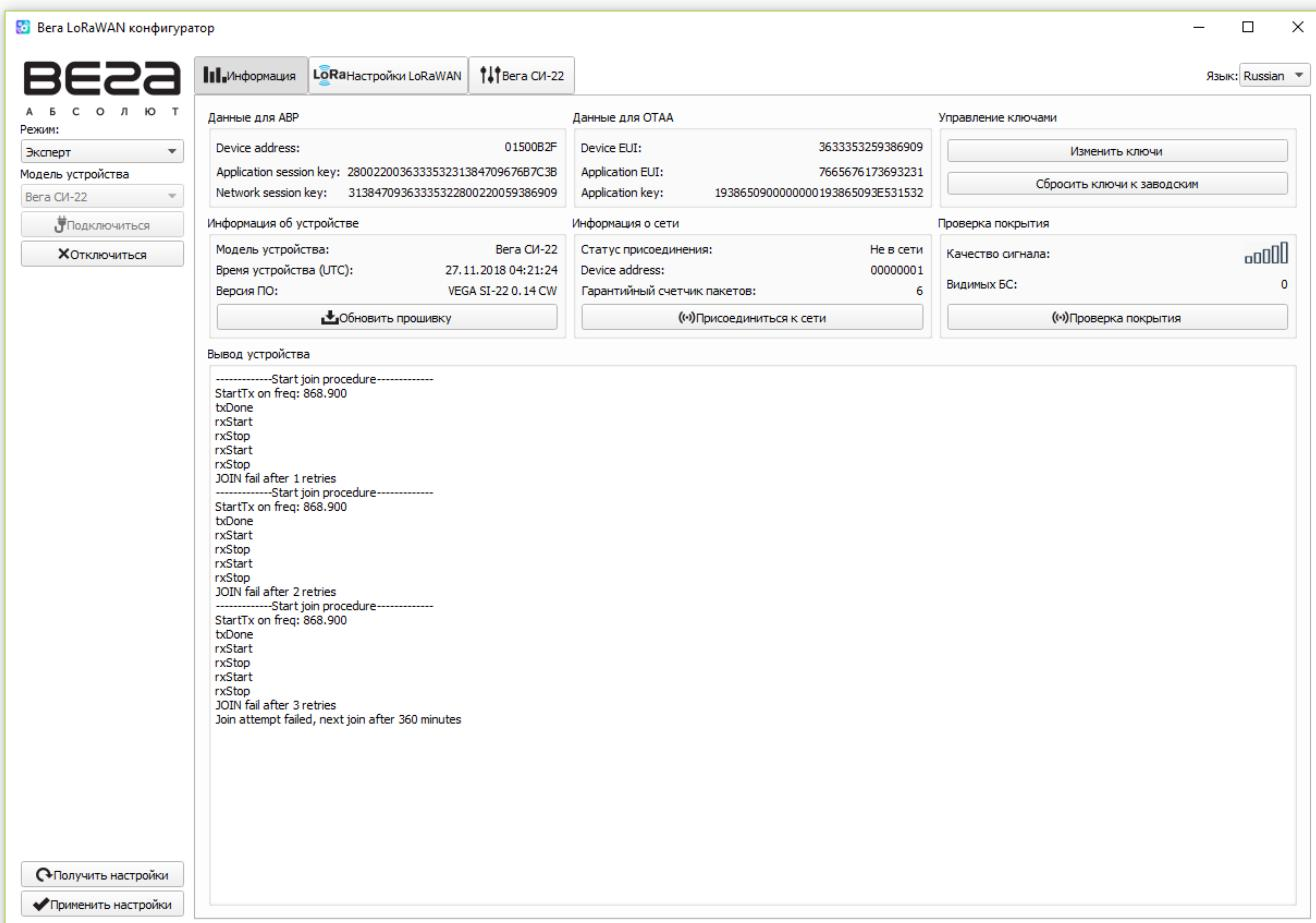
Для считывания настроек с устройства нужно нажать кнопку «Получить настройки», до этого момента в программе будут отображаться настройки по умолчанию или с последнего подключенного устройства.
