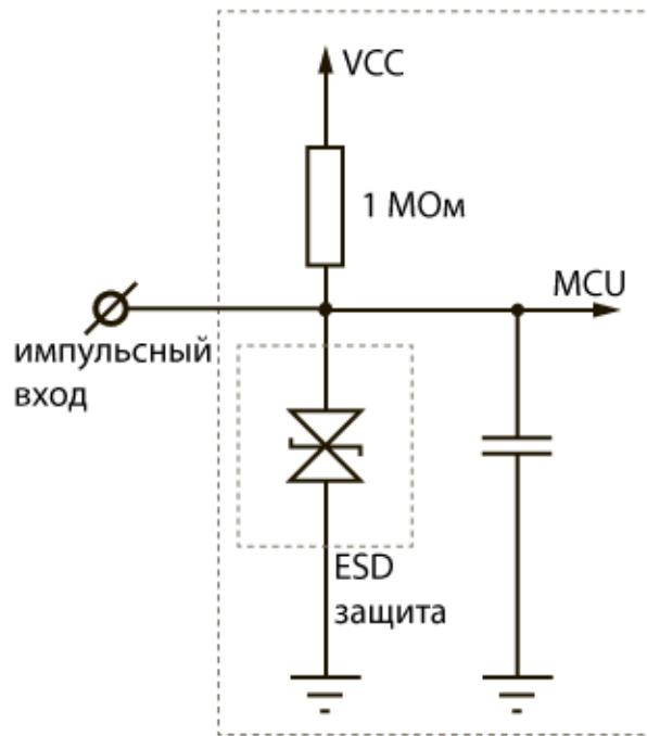
Счетчик импульсов имеет 4 импульсных входа и позволяет подключать цепи со следующими типами замыкающих контактов:
